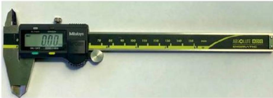
**Figura 2** Calibrador Vernier o Pie de Rey digital.
